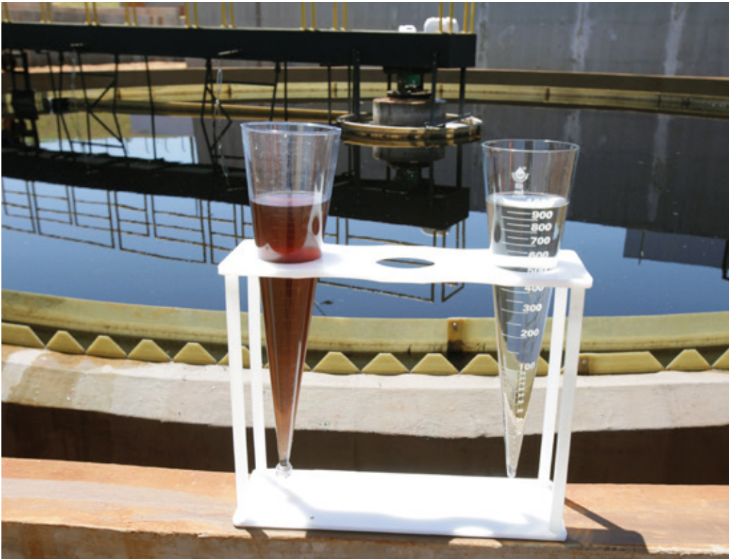
Cones de Imhoff usados para verificação da sedimentação natural dos sólidos em suspensão da Estação de Tratamento de Efluentes (ETE). Na foto, comparação do efluente de entrada (esquerda) em relação ao efluente de saída da ETE (direita). Unidade de Minga Guazú, Paraguai.
