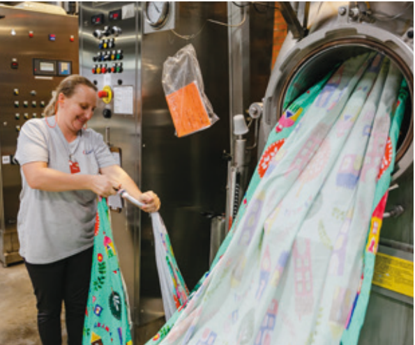
Máquinas de tingir com relação de banho reduzidas: usam menos água para tingir um quilo de malha.
